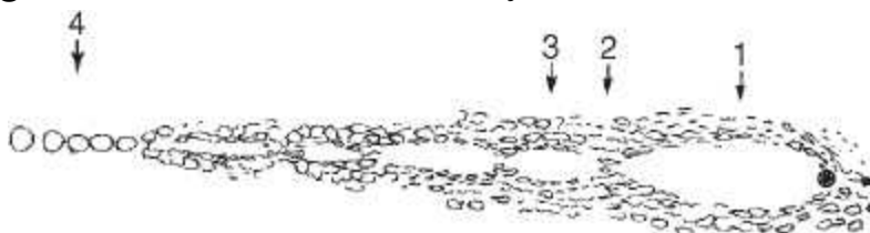
Figura 4.44 Formação da cavidade temporária e da lesão definitiva: (1) primeira expansão; (2) primeiro colapso; (3) segunda expansão; (4) rastros de bolhas de ar (apud Berlin, in Delmonte).
