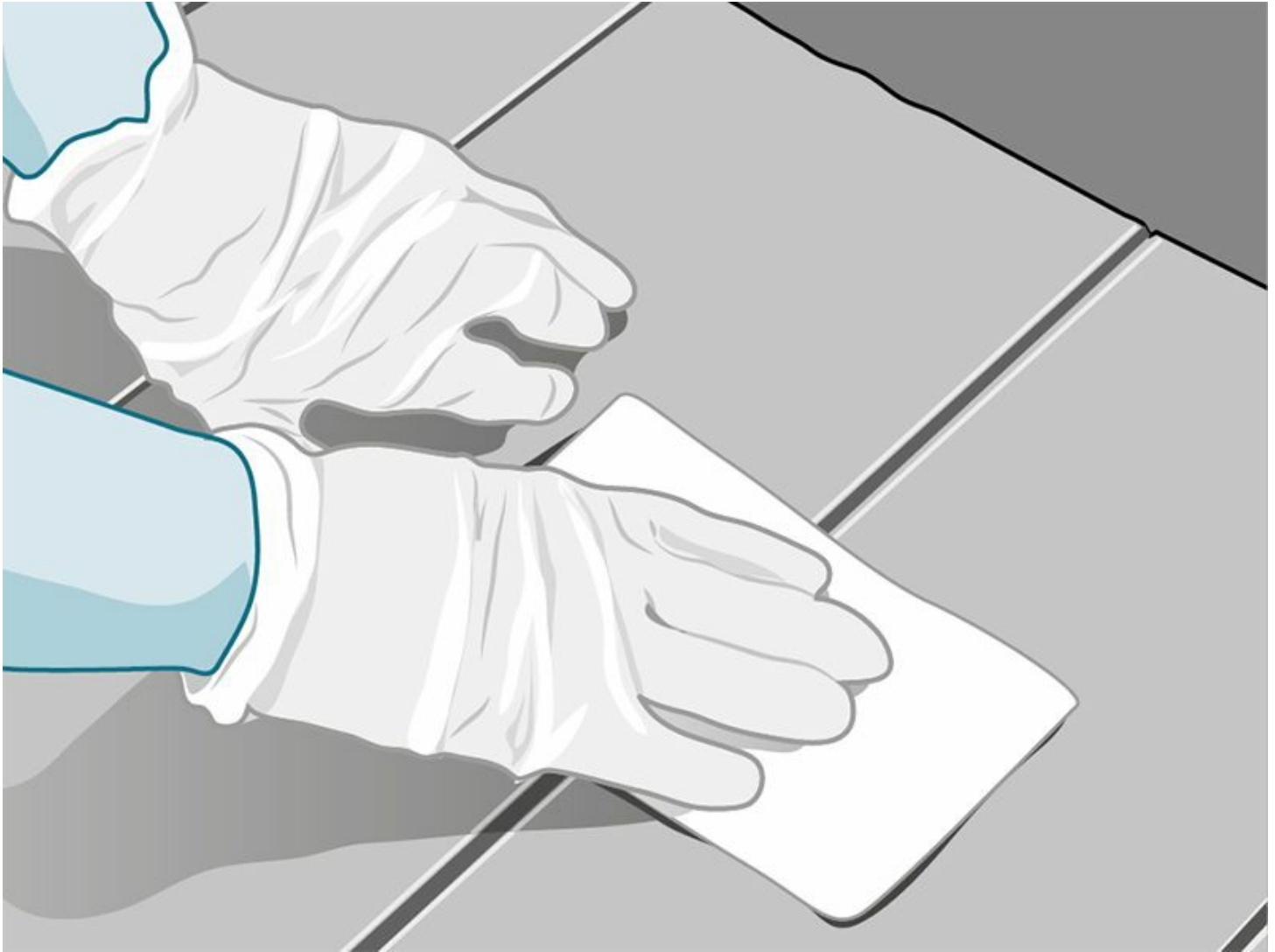
▲ Figura 39–6 Wipe sampling de superfície para determinar o potencial de contaminação por chumbo.
