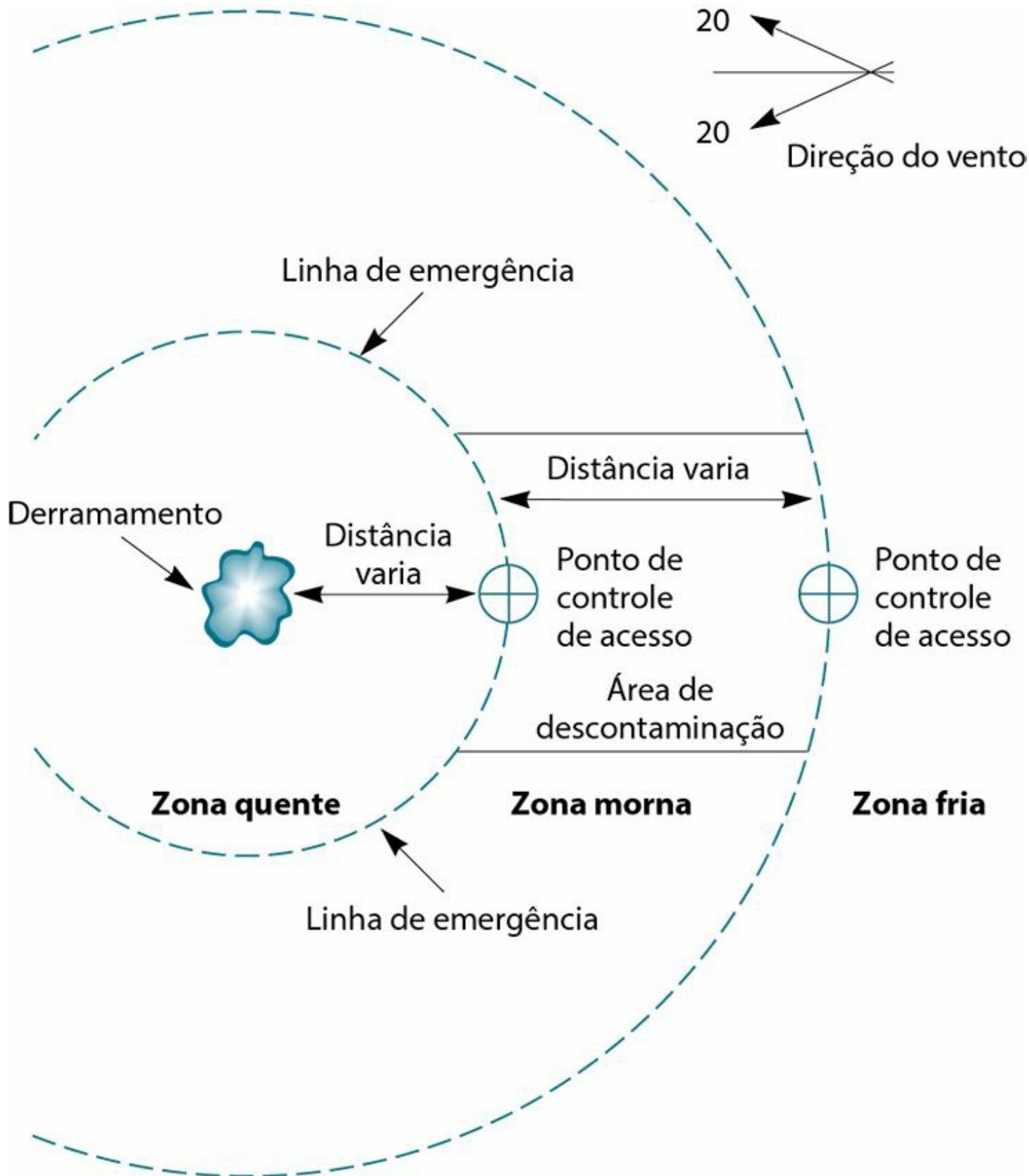
▲ Figura 45-2 Esquema de zonas quente, morna e fria em um local de derramamento de materiais perigosos.
