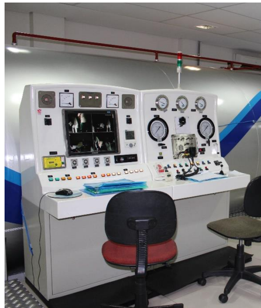
Figura.6 e 7: Painéis de controle interno e externo de Câmara Hiperbárica Multiplace.
